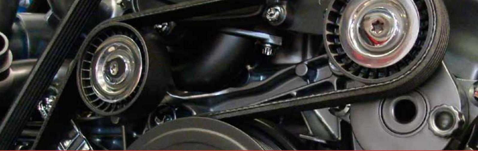
Las transmisiones en serpentín se componen de una sola correa acanalada que propulsa varios accesorios de motor. La gran mayoría de los vehículos equipados con estas transmisiones, tienen un tensor automático. La tensión se suministra por un fuerte resorte, situado en el centro de una cápsula que se parece a una pequeña lata, a la cual una polea está fijada. La polea gira alrededor de la cápsula del resorte y genera una tensión de correa constante.
